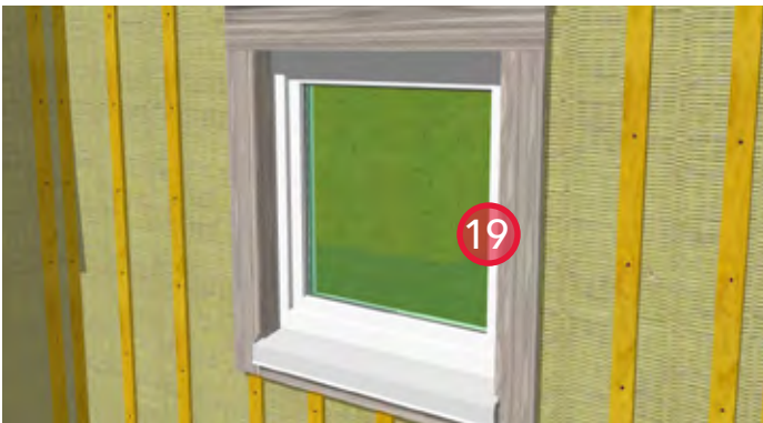
19. Install window trim.
